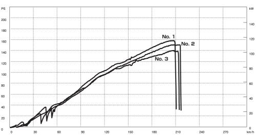
車両の故障診断コネクタ(OBDIIコネクタ)よりECU ReFlash を行うことができるセッティングツール"HKS フラッシュエディ ター" を使用し、チューニングレベルに応じてNo.1、No.2の2 種類のカスタムデータをご用意いたしました。
